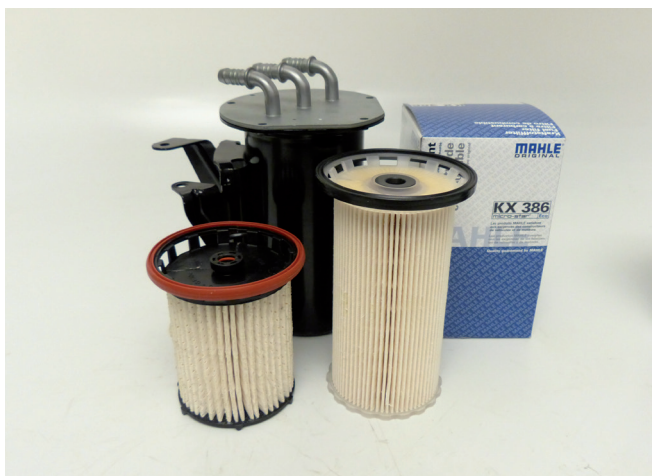
Рисунок 1: В одном и том же корпусе фильтра можно использовать два различных элементараразмеров
