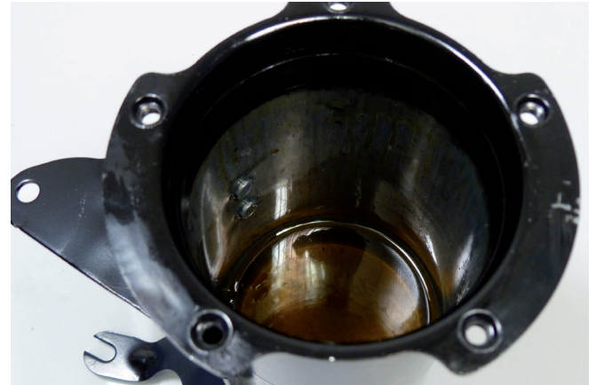
Figura 2: Combustible diésel usado en el alojamiento del filtro
