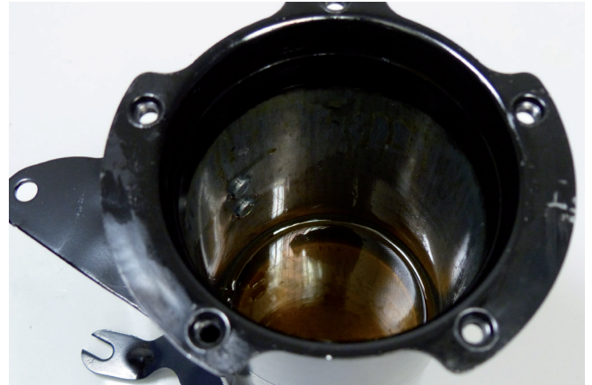
Εικόνα 2: Παλιό καύσιμο ντίζελ στο περίβλημα φίλτρου
