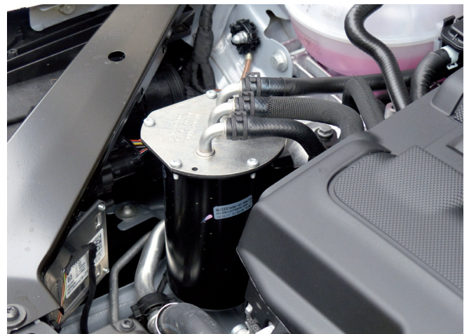
Εικόνα 3: Περίβλημα φίλτρου στο χώρο του κινητήρα
